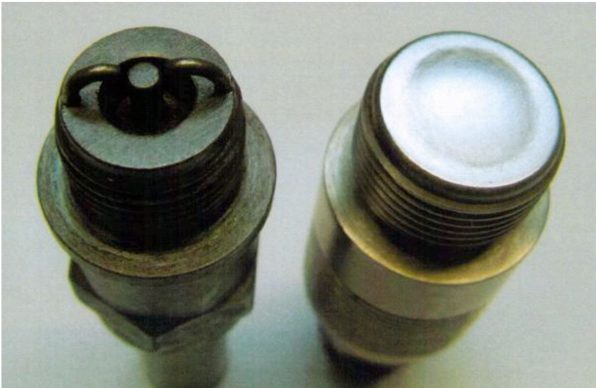
· 圖片1 - YИT-85儀器的爆震感應器與乾淨的火星塞。
